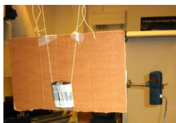
Figuur 376 – Registratie van de gedempte trilling van een slinger (rechts) met behulp van een ultrasone afstandssensor (links). De pieken in de registratie ontstaan als er geen goede reflectie is tegen de slinger.
