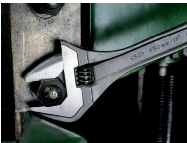
Figuur 413 – Een eenvoudig voorbeeld van de relatie tussen structuur en functie is de bahco: een moersleutel waarvan de breedte van de bek kan worden ingesteld door aan de ‘worm’ te draaien. Daarmee zijn moeren met verschillende afmetingen vast en los te draaien.
